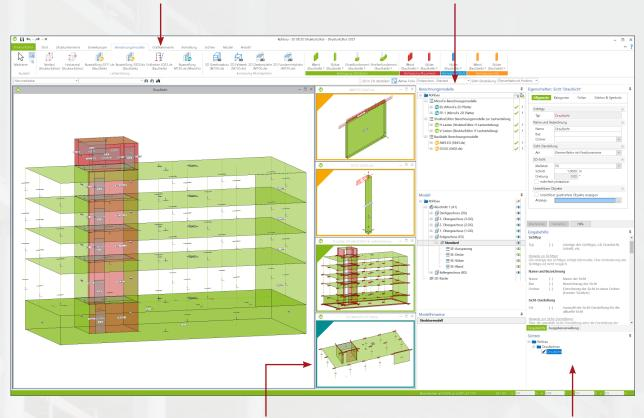
Alle Berechnungsmodelle, die zur Verteilung von vertikalen und horizontalen Belastungen oder zur Vorbereitung von Bauteil-Bemessungen vorliegen, werden in speziellen Berechnungssichten angezeigt. Die farbliche Markierung am Rand der Sicht zeigt die geplante Verwendung in der BauStatik, in MicroFe oder direkt im StrukturEditor an. Im Standardfall zeigt eine Berechnungssicht immer den kompletten Umfang des zugehörigen Berechnungsmodells an.
